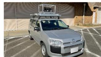
また、車載高速ビジョンシステムの例として、周辺環境における死角領域を深層学習により推定し、その領域を優先的に監視することで、死角から飛び出してくる自動車や歩行者の存在をいち早く検出する技術の開発を行っており、自動運転車の安全性の向上に資する技術の開発を行っています。また、前方を走る車両の見かけの大きさの変化を高速かつ高精度に計測し、距離・相対速度・相対加速度を推定することにより、前方までの車間距離を詰めたより経済的な隊列走行に寄与する技術の開発を行っています。
