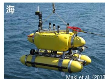
構築したアルゴリズムを自律型水中ロボットに搭載し、大型実験水槽において実証する。また、陸上走行型、ドローンを用いた飛行型のスカラー源探索ロボットの開発も進めている。
