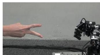
究成果は動画投稿サイトYouTubeにおいて、500万回以上の再生回数に達するなど、世界中で注目されている技術です。このように、高速なロボットシステムを応用することにより、従来とは異なる、新しい人間ロボット協調システム像を実現しています。人間の動作に低遅延で反応し、高速に追従する技術を応用することにより、じゃんけんロボット以外にも、人間との協調動作、人間の作業支援、人間の運動機能拡張等を実現しています。
