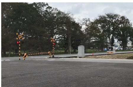
鉄道車両の位置情報を、携帯電話回線を用いてセンターサーバーに送信し、踏切警報機・遮断機を制御するシステムが株式会社京三製作所より提案されています。そのシステムを拡張すれば、自動車、交通信号機への信号の送信も可能になり、自動運転、運転支援車両、さらに電動車いす等を含めた、多モードの交通制御が可能になります。柏キャンパスでの鉄道試験線と ITS 実験フィールドを用いた実験により、実現可能性を検討しています。
