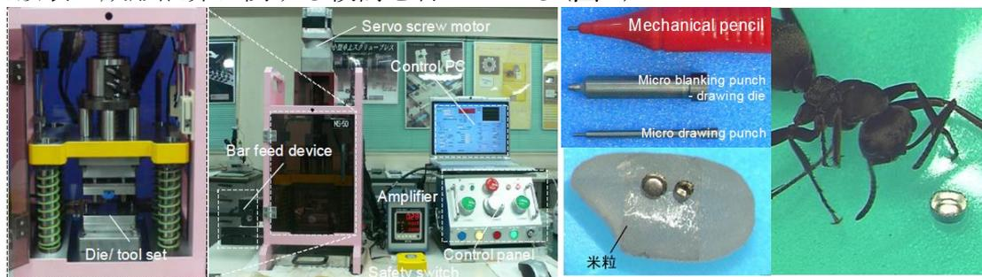
図3 医療、電子機器部品を対象にした微細精密プレス成形
