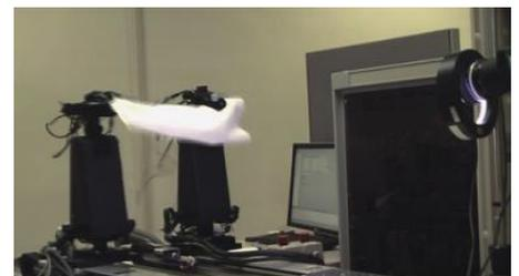
化していました。加えて、ロボットの軌道生成も困難になるため、その実現は困難でした。そこで本研究室では、これらの課題に対して、ロボットの高速運動性を利用することにより、柔軟物の変形が代数方程式で記述可能であることを理論的に示し、かつロボットの制御則や軌道生成を簡易化することに成功しています。この成果と高速視覚制御を統合し、布の動的折り畳み動作を実現しています。また、その前工程も含めたより現実的なタスクとして、乱雑に置かれた状態の布から1枚を取り出して吊下げ、デプスカメラや機械学習を含む画像処理を用いてコーナを探索し、その位置に合わせて布を展開する動作を生成することで、1枚30秒程度と従来研究の分オーダーと比べて高速な整列動作を実現しています。
